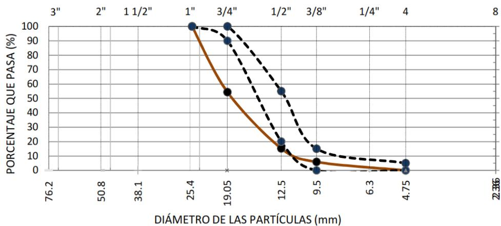
**Figura 3. Análisis granulométrico de agregado grueso.**
