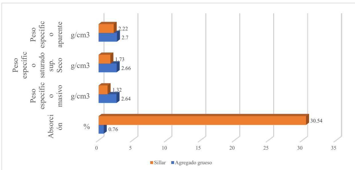
**Figura 6. Variación de propiedades de peso específico y absorción.**
