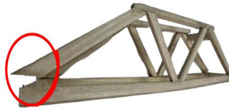
Figura. 9. Falla por construcción.
