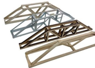
Figura. 7. Fotografía general de las vigas previo al ensayo.
