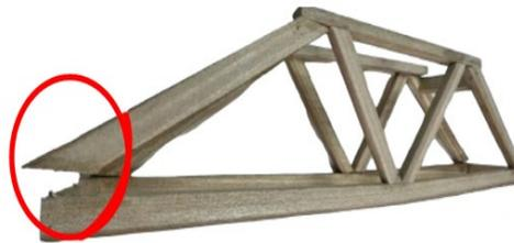
**Figura. 9. Falla por construcción.**
