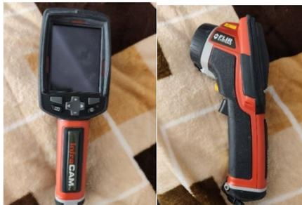
**Figura 3.** Cámara termográfica Flir I60. Fuente: elaboración propia.
