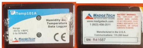
**Figura 4.** Sensor Data Logger Madgetech. Fuente: elaboración propia.
