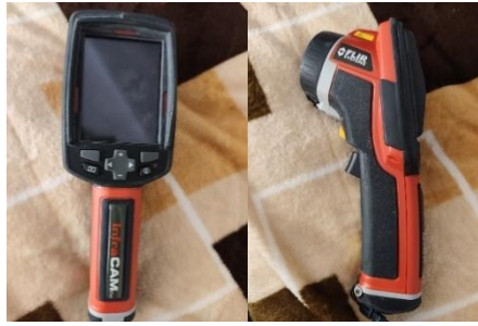
Figura 3. Cámara termográfica Flir I60. Fuente: elaboración propia.
