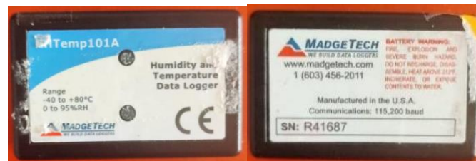
Figura 4. Sensor Data Logger Madgetech. Fuente: elaboración propia.
