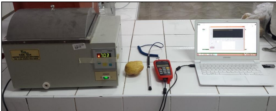
Figura 1. Sistema de calentamiento y adquisición de datos
