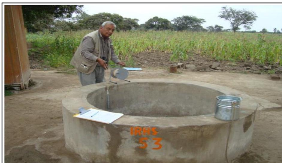
**Figura 10.** Medición del nivel estático en pozo tubular de propiedad de Empresa Agro Pucalá S.A. (IRHS 45)
